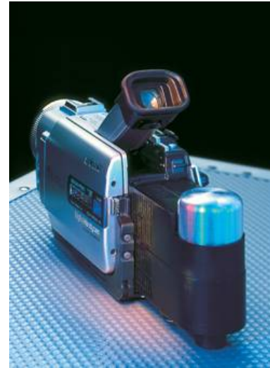
Brennstoffzellen-Energieversorgung für eine digitale Videokamera.
