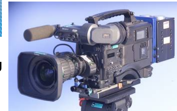
Brennstoffzellen-Energieversorgung für TV-Kamera
